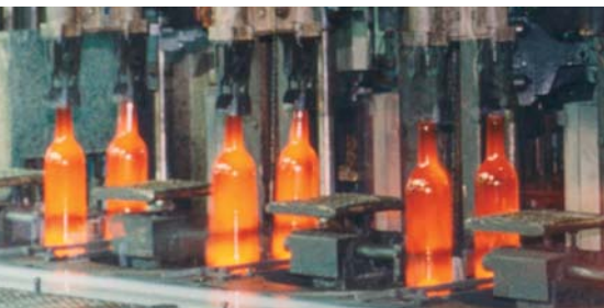
O carbonato de sódio denso é largamente utilizado na produção do vidro de embalagem
